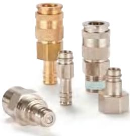
Enchufe automático industrial universal de 1/2" con perfil europeo estándar para su uso con grandes consumidores de neumáticos. Sistema de acoplamiento con operación de una sola mano. Válvula de alto caudal para un flujo óptimo y una baja caída de presión. La serie destaca por su robusto diseño (manguito de acero), un caudal extremadamente alto y una larga vida útil incluso con el uso más duro. El diseño del collarín minimiza los daños en el cuerpo de la válvula.
